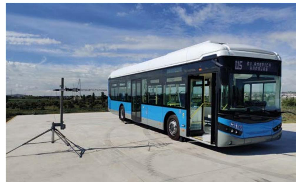
Ensayos según Reglamento 100-02 sobre la homologación de vehículos en relación con los requisitos específicos del grupo moto-propulsor, respecto a la seguridad eléctrica en vehículos y los requisitos de un sistema de acumulación de energía recargable (REESS)
