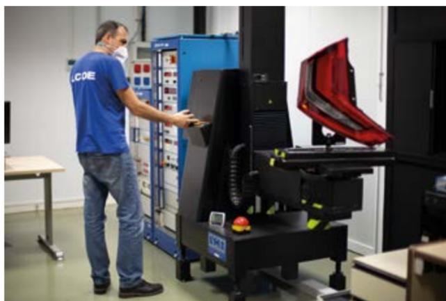
También se dispone de un laboratorio de vidrios y retrovisores que permiten homologar los parabrisas y lunas con que se equipan los vehículos, así como los ensayos de los limpia-lava parabrisas.
