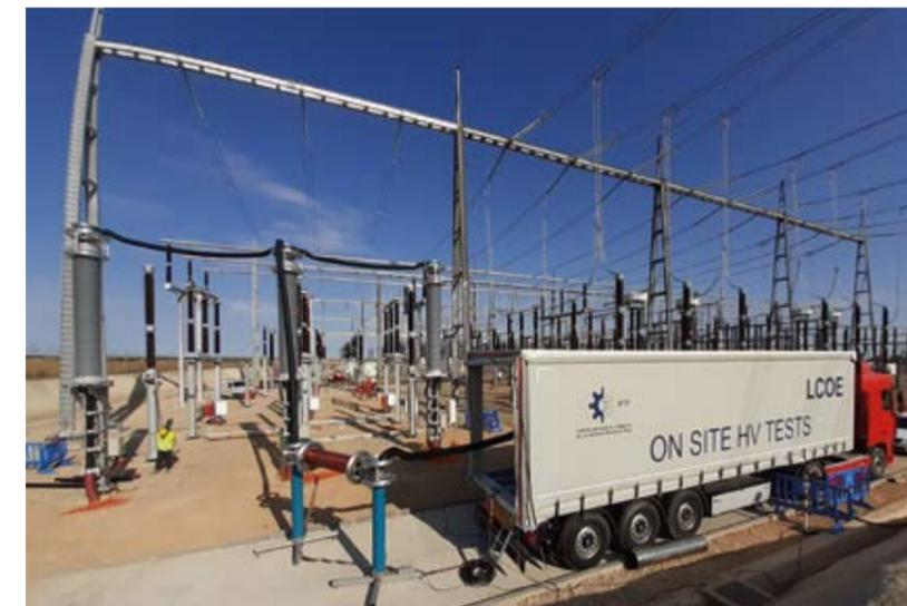
En el mes de septiembre de 2020 se puso en marcha un nuevo generador resonante móvil para los ensayos de puesta en servicio de líneas aisladas de alta tensión hasta 400 kV, que amplía la capacidad para atender la creciente demanda por parte de la industria eléctrica de los ensayos de sobretensión soportada y la comprobación del estado del aislamiento eléctrico de un sistema completo de cables.
