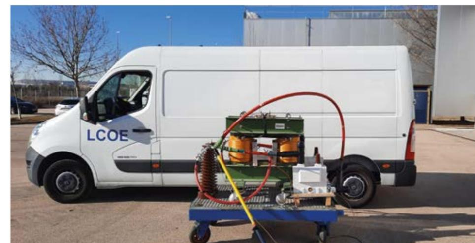
Instalación de calibración de sistemas de medida de energía para sistemas ferroviarios. Instalación móvil para "in situ"
