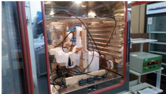
Ensayo de dispositivo lavaparabrisas en cámara de temperatura
