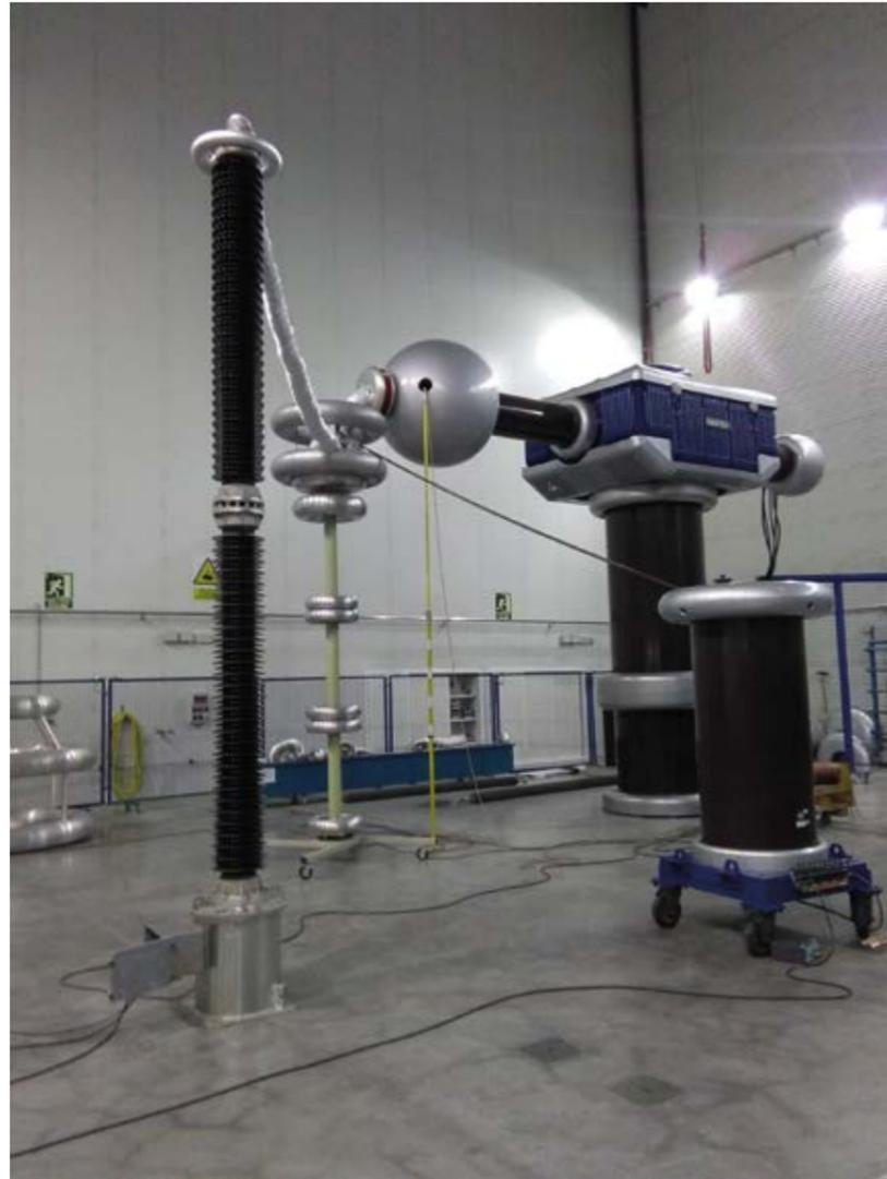
Con esta unidad, el CTAT completa un conjunto de cuatro generadores resonantes para llevar a cabo los ensayos "in situ" después de la instalación de los sistemas de cable y aparataje GIS prescritos en las normas y reglamentos correspondientes.
