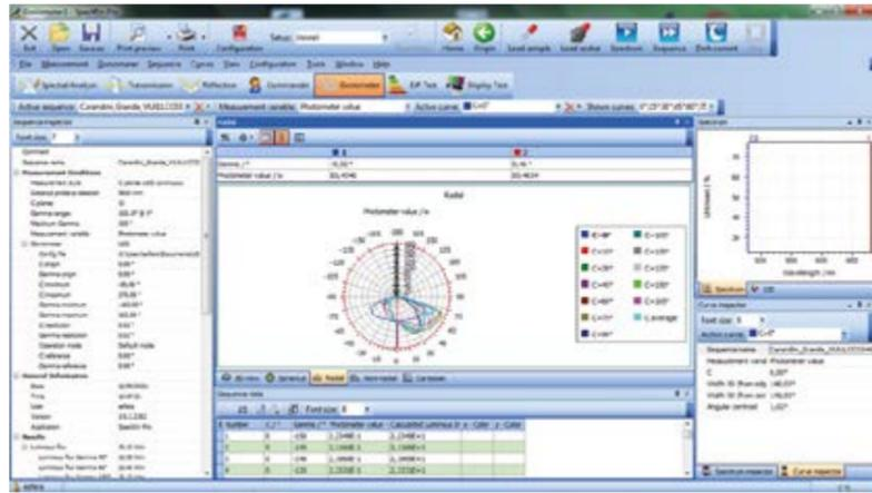
Se complementa la medida con el uso de dos espectros radiómetros, uno integrado en una esfera de Ulbricht de 165 cm de diámetro. Se pueden obtener datos espectrales de flujo luminoso y colorimétricos de las fuentes de luz. El segundo espectro nos permite la medida directa, tanto de irradiancia como de radiancia espectral, para evaluar el riesgo fotobiológico de fuentes de luz.
