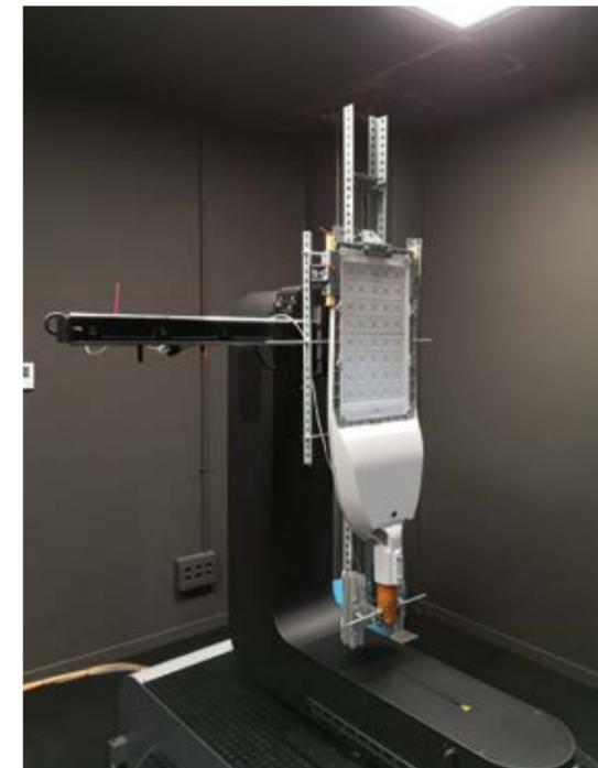
Se pueden obtener los datos más representativos como diagramas polares C-Gamma, matrices de intensidades, curvas isolux, diagramas cartesianos, diagramas de deslumbramiento, diagramas de flujo zonal, valores UGR, factores de utilización y porcentajes de flujos hemisféricos de las luminarias. Todos ellos se suministran en los formatos reconocidos internacionalmente, como son el formato IES o EU LUMDAT.
