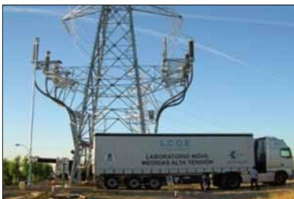
*Instalación de alta tensión resonante de 240 kV para ensayos in situ del LCOE*
