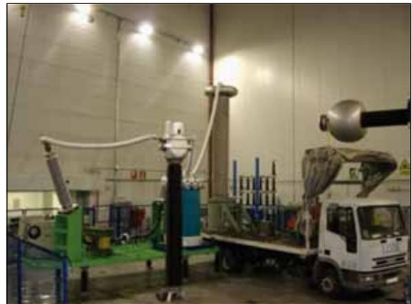
*Instalación de calibración de sistemas de medida de energía en AT*
