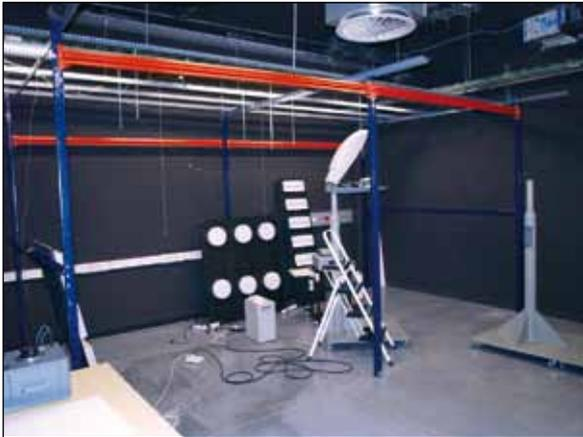
Adicionalmente se han configurado dos salas de ensayo para la realización de grados de protección IP para la evaluación de la estanquidad a las envolventes así como el grado de protección IK de resistencia mecánica. Se complementa con otra sala aneja donde se ubica una esfera de Ulbricht y diferentes equipos auxiliares para los ensayos.
