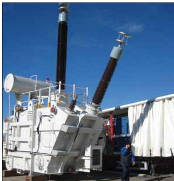
*Instalación de ensayo de transformadores de media potencia de hasta 700 MVA.*
