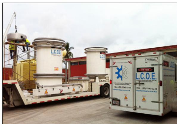
transformadores de hasta 700 MVA. Con estas instalaciones es posible efectuar el ensayo de tensión inducida de los transformadores de potencia a fin de conocer su estado de aislamiento y evitar fallos inesperados. Además es posible ensayar no solo los transformadores sino incluso los cables que se conectan a ambos lados (alta y media tensión), así como la aparatada a ellos conectada, p.e. celdas de MT o GIS de AT.
