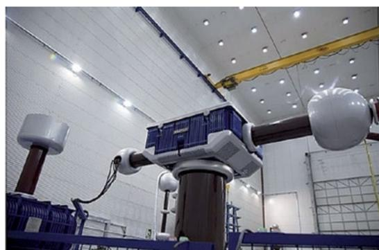
Durante 2015 se ha continuado la colaboración con el Laboratorio de Alta Tensión (LAT) de la ETSIDI de la UPM, lo que ha permitido la utilización de la instalación resonante de 700 kV del LAT para frecuencias comprendidas entre 30 Hz y 300 Hz, muy útil para ensayos tipo de cables de alta tensión, ensayos de recepción en cables de corta longitud (>100 m) y de subestaciones aisladas en gas (GIS).
