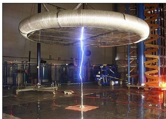
■ *Ensayos de impulsos de corriente tipo rayo para equipos eléctricos*
