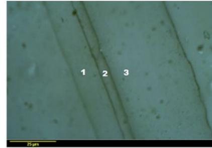
Micrografía óptica (500x) de una muestra de plástico tricapa de un envase brik
