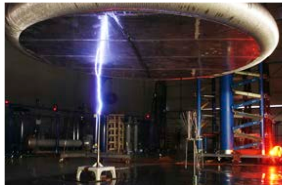
Descargas de impulso tipo rayo sobre pararrayos de referencia.
