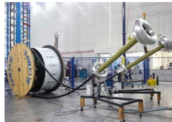
Montaje de la bobinas de cable con terminaciones de ensayo. Plataforma de ensayos AT de Tecnogetafe.
