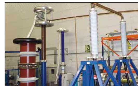
Ensayo de ciclos térmicos sobre sistema de cable de 132 kV.
