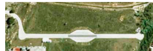
Pista ISO para mediciones de ruido de vehículos.
