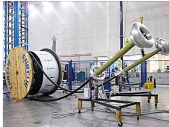
Montaje de la bobinas de cable con terminaciones de ensayo. Plataforma de ensayos AT de Tecnogetafe.
