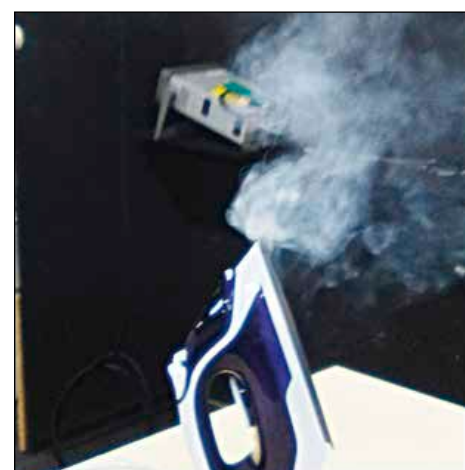
Ensayo de funcionamiento anormal de plancha.
