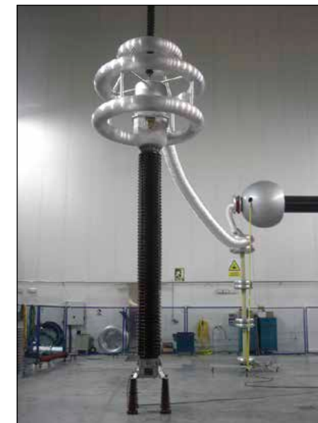
Medida de descargas parciales en transformador de intensidad de 420 kV para Arabia Saudí.
