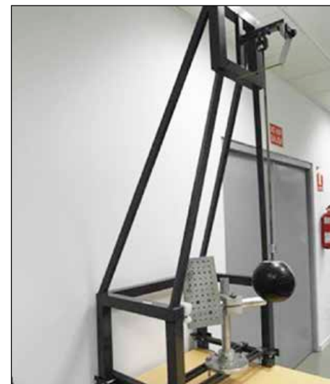
Péndulo para ensayo de retrovisores.
