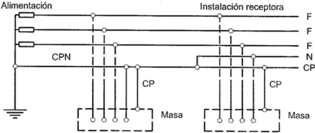
En los esquemas TN cualquier intensidad de defecto franco fase-masa es una intensidad de cortocircuito. El bucle de defecto está constituido exclusivamente por elementos conductores metálicos.
