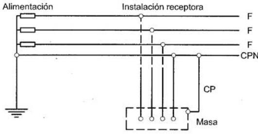
Esquema TN-C-S: En el que las funciones de neutro y protección están combinadas en un solo conductor en una parte del esquema (figura 3).
